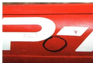
1 Im Wasser oder mit Spucke das Leck finden und mit Filzstift markieren.
