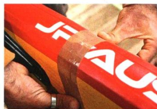
4 Den Flicker auf dem unaufgeblasenen Brett mittig auf das Loch legen. Reparatur wie oben beenden.
